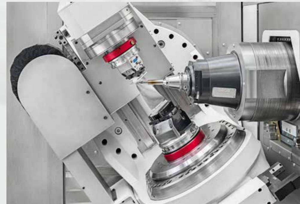
Vario-Rundtisch mit Gegenhalter und Tandemantrieb
