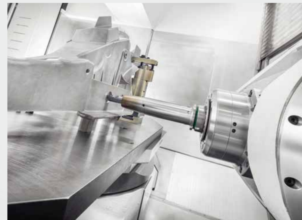
G600F – ein Maschinenkonzept für die Bearbeitung von Rahmenstruktur- und Fahrwerksteilen
