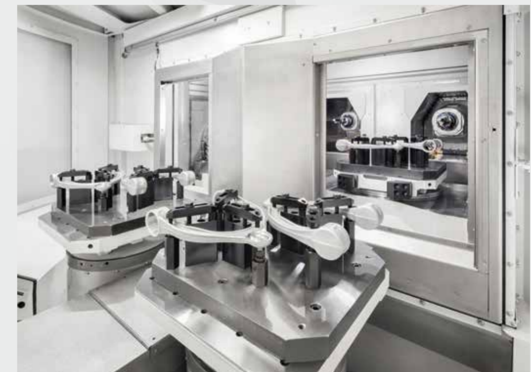
Bearbeitung von Querlenkern auf einem doppelspindigen G-Modul
