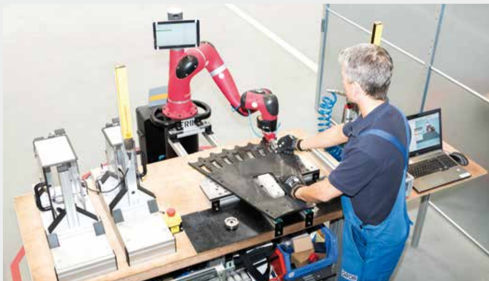
Robô auxiliando na montagem do ponto de fixação do magazine no Pavilhão 6
