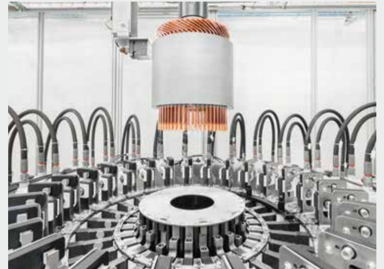
Instalação de produção Hairpin para a fabricação de estatores
