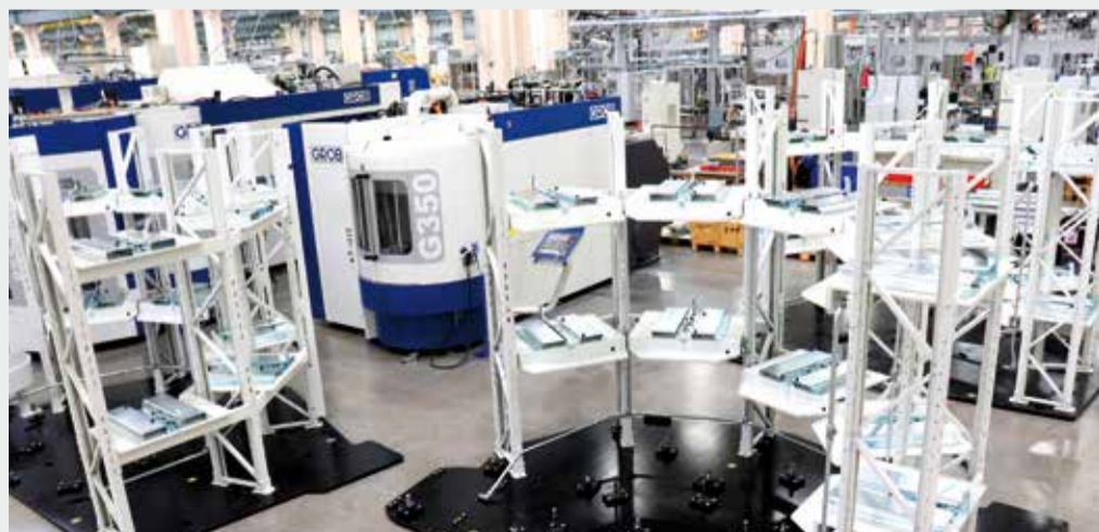
Módulos para o sistema rotativo de armazenamento de paletes PSS-R
