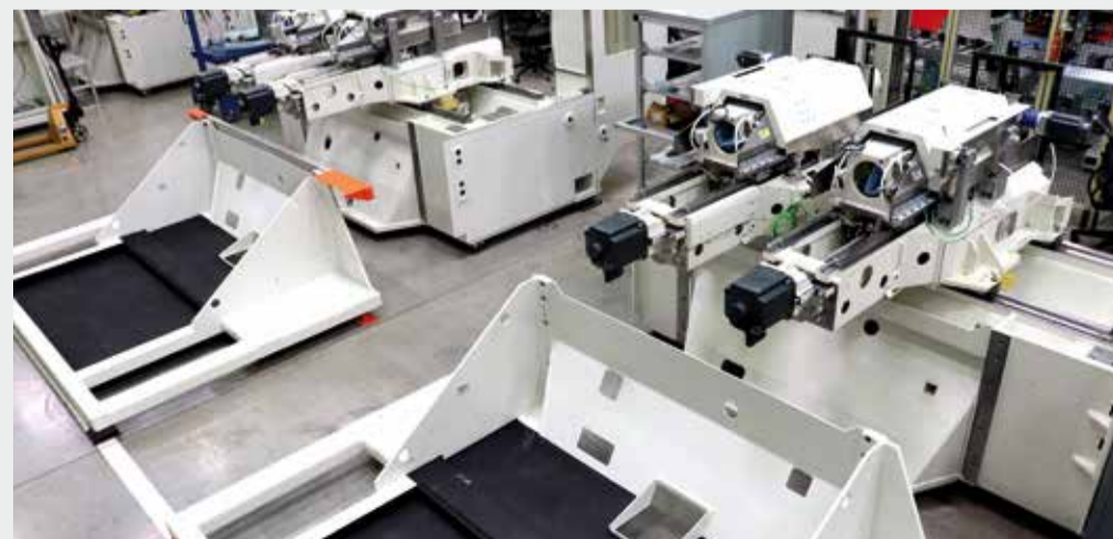
Dispositivo do fuso do motor para os módulos G bifusos
