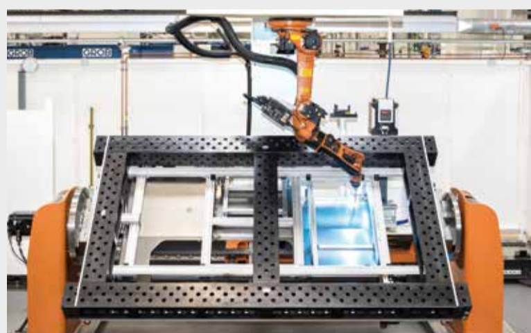
Fixador de capô com manuseio por robô
