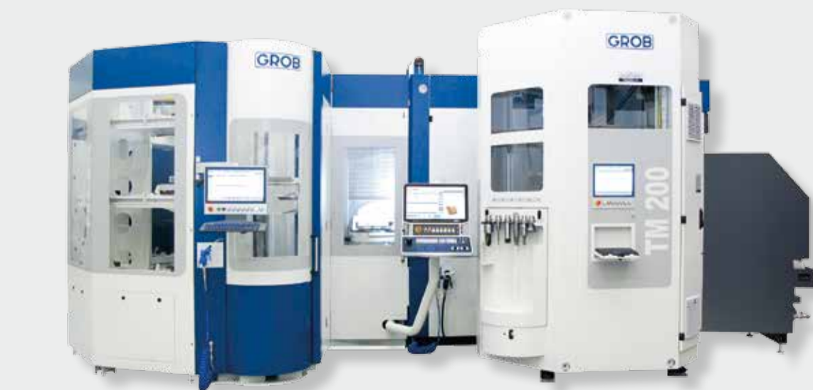
通过组合的托盘系统和工件处理系统实现自动化
