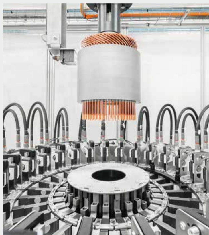
用于生产定子的 U 形生产设备
