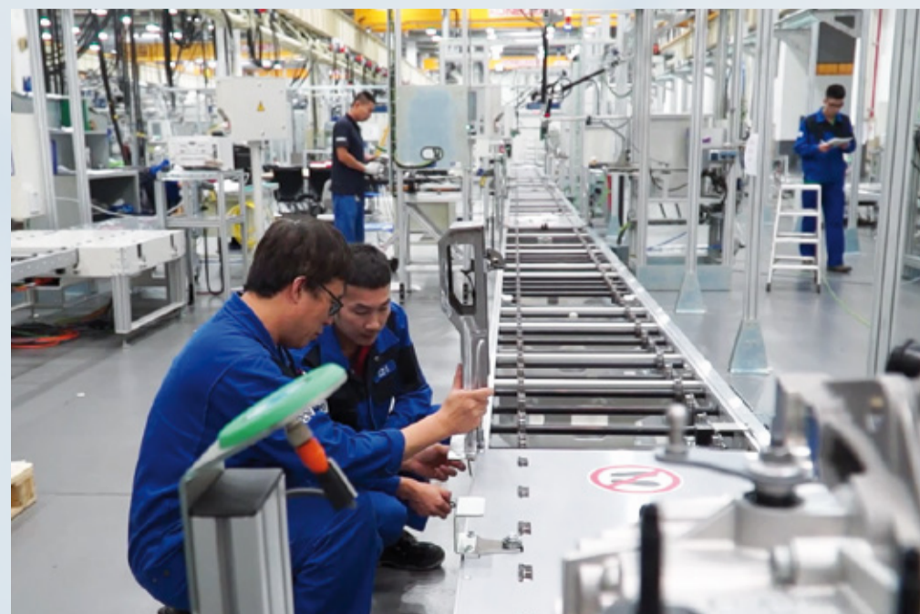
电动机装配线
